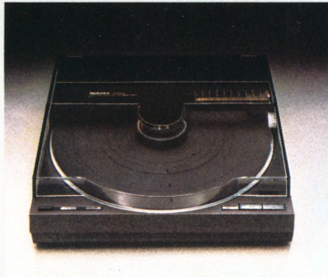
SL-7 Vollautomatischer Plattenspieler mit quarzgeregeltem Direktantrieb; servogeregelter Tangentialtonarm. Gleichlaufschwankungen 0,035%. Horizontal- und Vertikalbetrieb möglich. Inkl. Magnettonabnehmer EPC-202. Gehäusefarbe: Schwarz + Silber.
